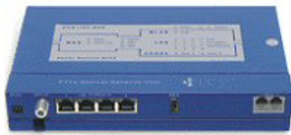
Figuur 9 Residential Gateway met aansluitingen voor kabeltv en –radio (links), pc aansluitingen(midden) en telefoonaansluitingen (rechts)
