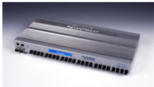
Figuur 13 Centrale apparatuur voor dataverkeer met glasvezels
