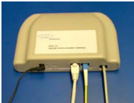
Figuur 12 Koppeleenheid voor data- en telefoongebruik Van links naar rechts voeding, Pc aansluiting, glasvezelaansluiting en telefoonaansluiting
