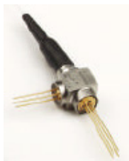
Figuur 5 BiDi : de glasvezel bevindt zich in de zwarte kabel bovenin
